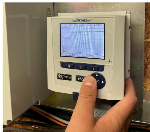
Mit einem WTW-Controller mit Display haben Sie immer den kompletten Überblick über die Sauerstoffwerte in allen geschlossenen Fischkäfigen. Mit diesen Messwerten können sie Pumpen und Sauerstoffzufuhr direkt steuern oder die Signale an die SPS senden. Es gibt auch eine Option für eine webbasierte Lösung.
